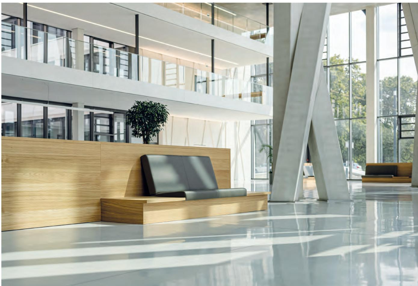
Bild 3: Die Haupteinschließung der Hauptverwaltung der HeidelbergCement AG erfolgt über das repräsentative Foyer, das drei Geschosse hoch ist und im Inneren viel Sichtbeton zeigt. Eingesetzt wurde ein selbstverdichtender Feinbeton der höchsten Sichtbeton-Klasse SB 4 für die z.T. filigranen und dicht bewehrten Bauteile, wie Stützen, Wände und die drei im Raum stehenden, spektakulären Baumstützen.
