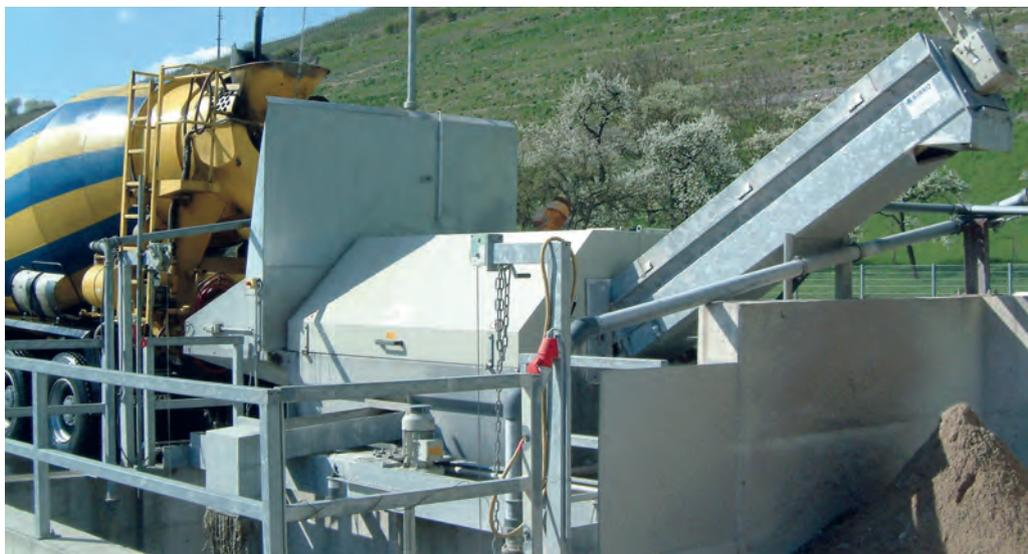
Die Bibko-Recyclinganlage Typ ComTec 20/30 recycelt den Restbeton so, dass Sand und Kies nach dem Recyclingprozess wiederverwendet werden können.
