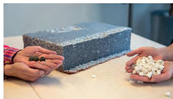
Werden Wärmedämmverbundsysteme (Mitte) im Zementwerk verwertet, kann der enthaltene Putz als Rohmehlkomponente zur Herstellung von Zementklinker (links) verwendet und das EPS (rechts) energetisch genutzt werden.
